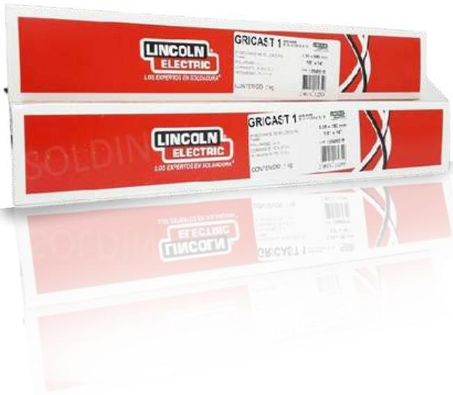
Electrodo de revestimiento gráfico-básico conductor de la electricidad, lo cual le permite operar con bajas densidades de corriente, facilitando su empleo con técnicas de soldadura en frío. Sus depósitos son de alto tenor de níquel, dúctiles, resistentes a la fisuración, maquinables y de buena apariencia.
